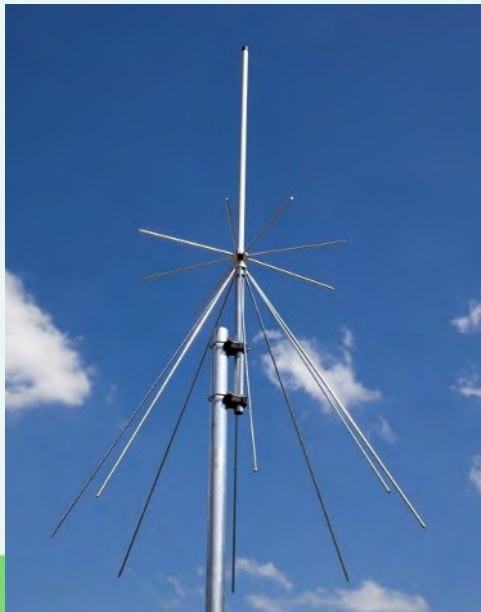
La discone de 50 à 2000MHz utilisée pour la bande 145 / 146 FM.
